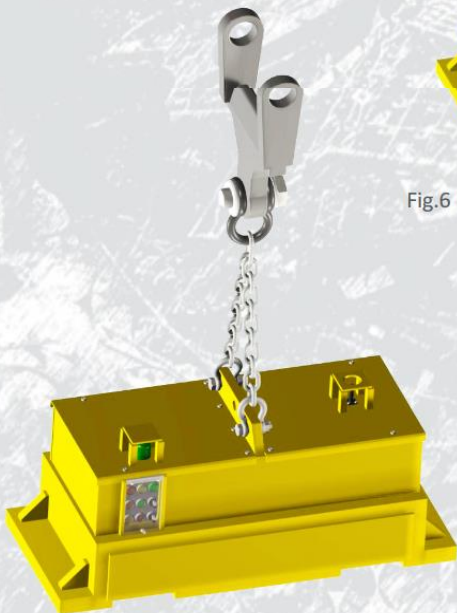
Fig.7 | Suspensión con cadena de 2 ramales
